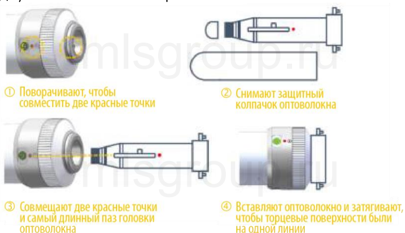
Рисунок 2-3 Способ соединения QBH и оптоволокна
